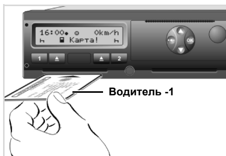
Рис. 54. Ввод карты первого водителя в тахограф
