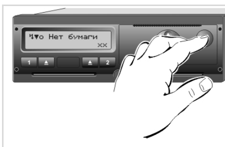
Рис. 43. Индикация при отсутствии бумаги в лотке принтера
